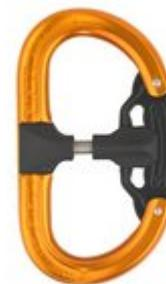
Einzigartiger, patentierter Autolock Karabiner mit zwei identischen Kammern, die sich mittels geführter Feder nur wechselseitig öffnen lassen und automatisch schließen, sobald man die Feder loslässt. Eine Kammer bleibt immer geschlossen. Die Kammern lassen sich nur wechselseitig öffnen. Die ovale Form verhindert eine schwächende Querbelastung. Der FIFTY:FIFTY ist gleichermaßen für Rechts- und Linkshänder geeignet und kann einhändig bedient werden.
