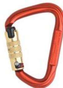
Der 2800 EVO ist ein großer Aluminiumkarabiner in HMS-Form mit weiter Schnapperöffnung und hohen Festigkeitswerten. Als 3-Wege-Autolock für mehr Sicherheit. Für Öffnung: heben-, drehen und drücken.
