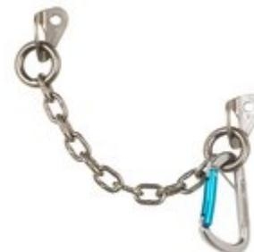
Kettenstand mit zwei 10 mm Laschen, einer Kette und einem D-Form Schnappkarabiner mit Splint. Der empfohlene Bohrlochabstand beträgt 25-30 cm.
