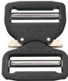
Die COBRA® PRO STYLE ist die weltweit führende Sicherheits-Schnalle aus Aluminium. Dank ihres patentierten Verschlussmechanismus und hohen Bruchkraftwerten bietet sie das höchste Maß an Sicherheit. In Verbindung mit dem passenden Gurt hält der Verschluss garantiert 9 kN auf geraden Zug und 18 kN in der Umreifung.
