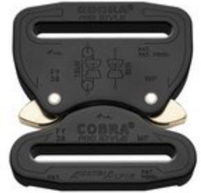
Die COBRA® PRO STYLE ist die weltweit führende Sicherheits-Schnalle aus Aluminium. Dank ihres patentierten Verschlussmechanismus und hohen Bruchkraftwerten bietet sie das höchste Maß an Sicherheit. In Verbindung mit dem passenden Gurt hält der Verschluss garantiert 9 kN auf geraden Zug und 18 kN in der Umreifung.
