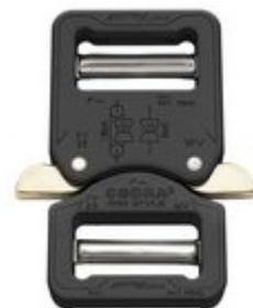
Die COBRA® PRO STYLE ist die weltweit führende Sicherheits-Schnalle aus Aluminium. Dank ihres patentierten Verschlussmechanismus und hohen Bruchkraftwerten bietet sie das höchste Maß an Sicherheit. In Verbindung mit dem passenden Gurt hält der Verschluss garantiert 9 kN auf geraden Zug und 18 kN in der Umreifung.
