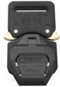
Die neue COBRA® PRO STYLE SNAKEBITE ist eine Sicherheitsschnalle, die auf dem patentierten Verschlusssystem der COBRA® PRO STYLE basiert. Sie besteht aus Aluminium und ist mit einem zusätzlichen Klemmelement ausgestattet, welches das längenverstellbare Gurtband an der gewünschten Position fixiert und ein mögliches „Kriechen“ des Gurtbandes verhindert.
