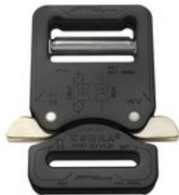
Die COBRA® PRO STYLE ist die weltweit führende Sicherheits-Schnalle aus Aluminium. Dank ihres patentierten Verschlussmechanismus und hohen Bruchkraftwerten bietet sie das höchste Maß an Sicherheit. In Verbindung mit dem passenden Gurt hält der Verschluss garantiert 9 kN auf geraden Zug und 18 kN in der Umreifung.
