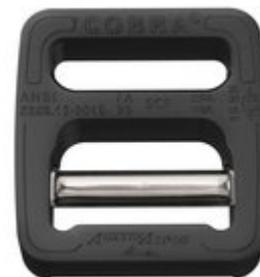
Die COBRAFRAME 18 kN Rückfädelschnalle aus Aluminium mit beweglichem Mittelsteg aus Edelstahl entspricht dem ANSI Z359.12-2019 Standard und überzeugt mit 15 kN Bruchkraft auf geraden Zug. In Verbindung mit dem passenden Gurt garantieren wir jedoch 18 kN und weisen dies in den technischen Daten entsprechend aus. Stretch-Version für die Anwendung mit dicken Gurtbändern.
