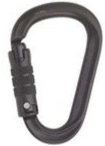
Der HMS RONDO erfüllt alle Anforderungen hinsichtlich einfachen Handlings und fühlbarer Sicherheit. Der runde Querschnitt am oberen Schenkel verhindert eine durch Seilreibung verursachte Kantenbildung und unterstützt zudem eine flüssige Seilführung. Er ist der ideale Karabiner für jegliche Anwendung mit dem Seil.
