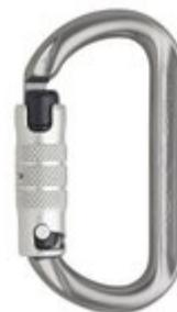
OVALO – der Yogi unter den Karabinern: Seine ovale Form begünstigt die optimale Ausrichtung des Karabiners nach der Längsachse und vermindert somit gefährliche Querbelastungen in jeder Situation. Zusätzlich verhindert der runde Querschnitt eine durch Seilreibung verursachte Kantenbildung und unterstützt zudem eine flüssige Seilführung. Das besondere Merkmal des OVALO ID ist die individuelle Nummerierung [ID]. Der Ovalkarabiner als 3-Wege-Autolock. Für Öffnung: heben-, drehen und drücken.
