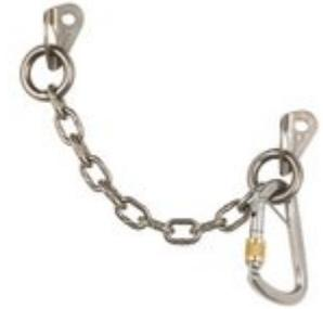
Kettenstand mit zwei 10 mm Laschen, einer Kette und einem D-Form Schraubkarabiner mit Splint. Der empfohlene Bohrlochabstand beträgt 25-30 cm.
