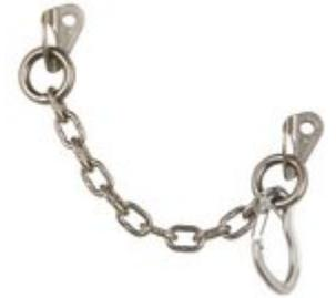
Kettenstand mit zwei 10 mm Laschen, einer Kette und einem MICRO Drahtbügelkarabiner mit Splint. Der empfohlene Bohrlochabstand beträgt 25-30 cm.
