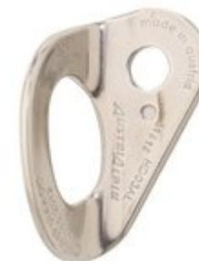
Bohrhakenlasche mit 10 mm Bohrung und großer Öse. Nur mit Schwerlastanker aus Edelstahl verwenden. Beachte die aktuelle UIAA Veröffentlichung zum Thema Spannungskorrosion in unserer Knowledgebase.
