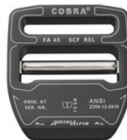
Die COBRAFRAME 18 kN Rückfädelschnalle aus Aluminium mit beweglichem Mittelsteg aus Edelstahl und Easy-Release-Funktion für extra schnelles Lösen mit dem Daumen entspricht dem ANSI Z359.12-2019 Standard und überzeugt mit 15 kN Bruchkraft auf geraden Zug. In Verbindung mit dem passenden Gurt garantieren wir jedoch 18 kN und weisen dies in den technischen Daten entsprechend aus. Stretch-Version für die Anwendung mit dicken Gurtbändern.
